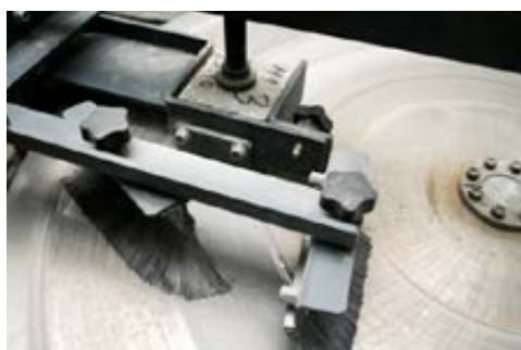
DLAŽBA PŘI ZKOUŠCE OHRUBNOST PVRCHU
