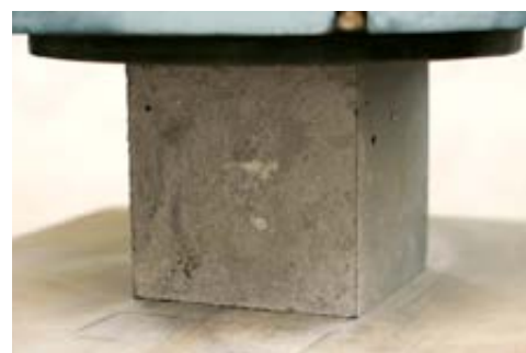
BETON PŘI ZKOUŠCE PEVNOST V TLAKU
