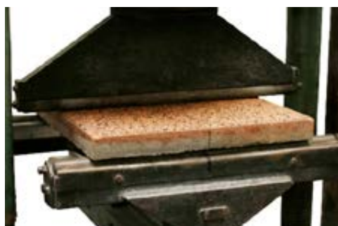
DLAŽBA PŘI ZKOUŠCE PEVNOST V DHYBU
