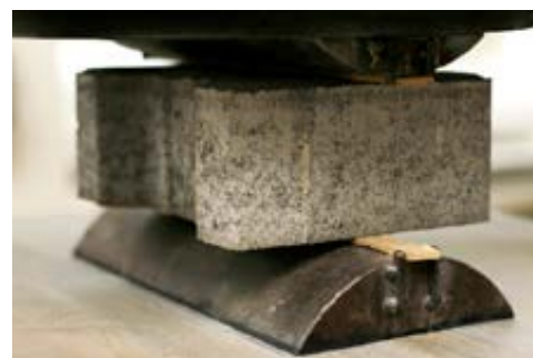
DLAŽBA PŘI ZKOUŠCE PEVNOST V PŘÍČNÉM TAHU
