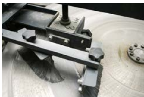
DLAŽBA PŘI ZKOUŠCE OBRUSNOST POVRCHU
