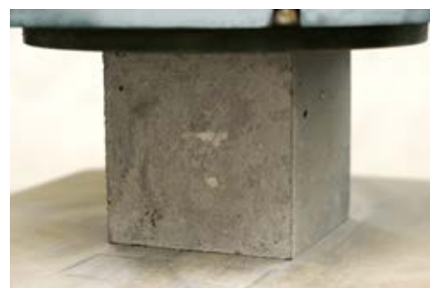
BETON PŘI ZKOUŠCE PEVNOST V TLAKU
