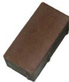
Povrch dlažby bez vápenného výkvvětu
