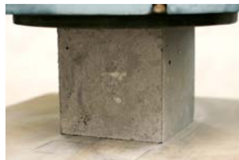
BETON PŘI ZKOUŠCE PEVNOST V TLAKU
