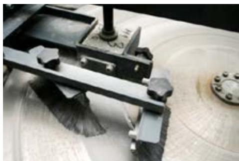
DLAŽBA PŘI ZKOUŠCE OBRUSNOST POVRCHU
