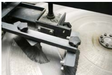
DLAŽBA PŘI ZKOUŠCE OBRUSNOST POVRCHU
