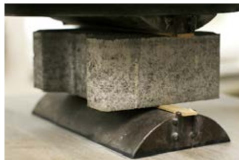
DLAŽBA PŘI ZKOUŠCE PEVNOST V PŘÍČNÉM TAHU
