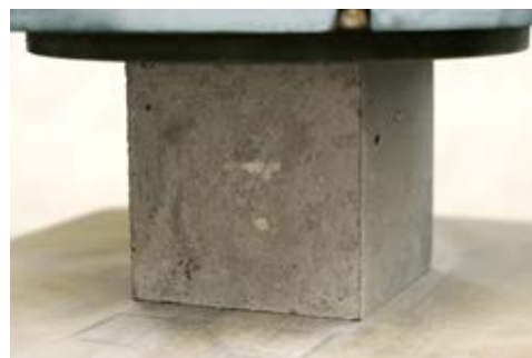
BETON PŘI ZKOUŠCE PEVNOST V TLAKU
