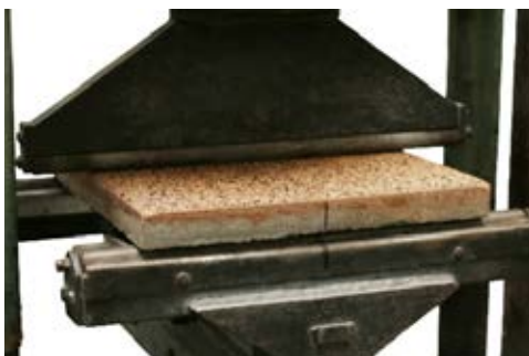
DLAŽBA PŘI ZKOUŠCE PEVNOST V DHYBU
