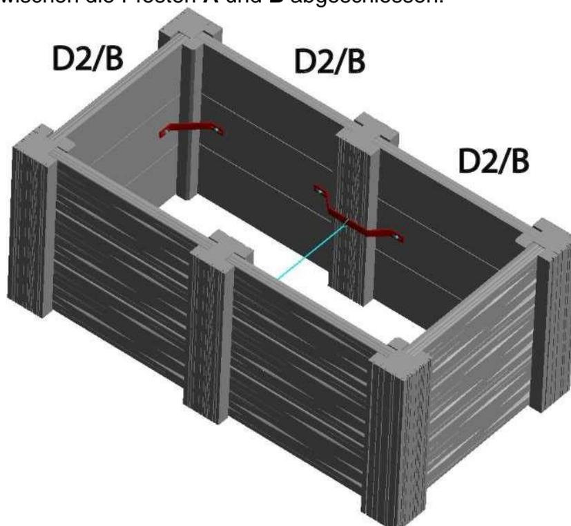
**ABSCHLIEßEND:** Einzelne Bauteile des BEETES während der Montage befestigen, jedoch nicht festziehen, um ein kleines Spiel beim Zusammenbau von anderen Bauteilen zu erhalten. Die Bauteile erst nach dem erfolgten Zusammenbau von allen Bauteilen des BEETES endgültig festziehen. Das endgültige Festziehen ist mit einem gewissen Gefühl durchzuführen, damit die einbetonierten Gewindehülsen nicht herausgerissen werden.
