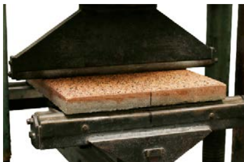
DLAŽBA PŘI ZKOUŠCE PEVNOST V DHYBU
