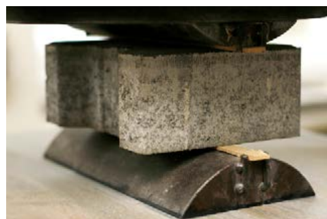
DLAŽBA PŘI ZKOUŠCE PEVNOST V PŘÍČNÉM TAHU
