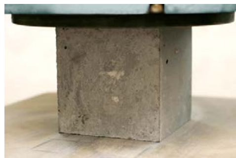
BETON PŘI ZKOUŠCE PEVNOST V TLAKU
