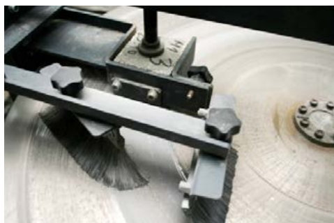
DLAŽBA PŘI ZKOUŠCE OBRUSNOST POVRCHU
