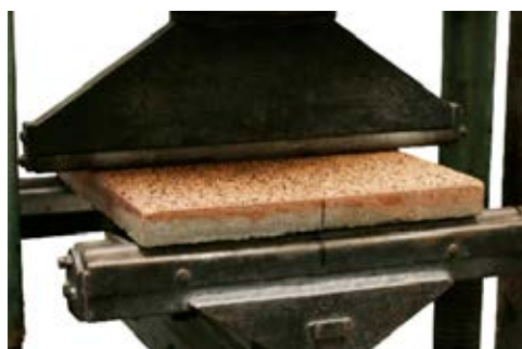
DLAŽBA PŘI ZKOUŠCE PEVNOST V DHYBU
