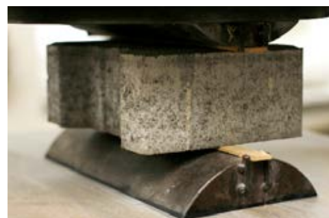
DLAŽBA PŘI ZKOUŠCE PEVNOST V PŘÍČNÉM TAHU
