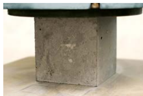
BETON PŘI ZKOUŠCE PEVNOST V TLAKU
