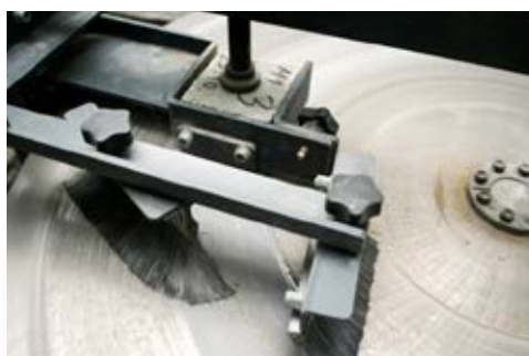
DLAŽBA PŘI ZKOUŠCE OBRUSNOST POVRCHU
