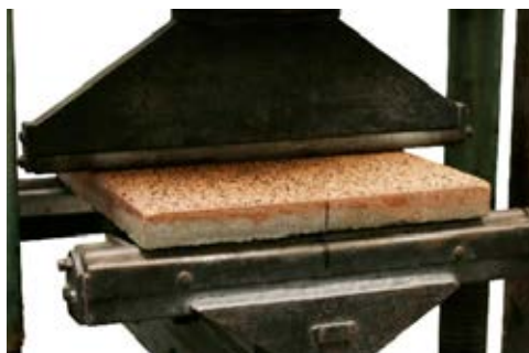
DLAŽBA PŘI ZKOUŠCE PEVNOST V DHYBU
