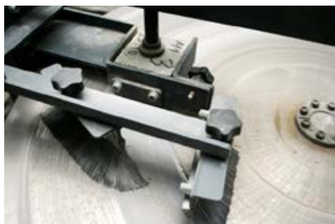
DLAŽBA PŘI ZKOUŠCE OBRUSNOST POVRCHU
