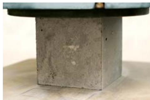
BETON PŘI ZKOUŠCE PEVNOST V TLAKU
