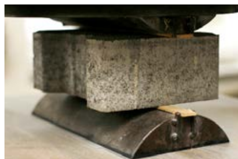
DLAŽBA PŘI ZKOUŠCE PEVNOST V PŘÍČNÉM TAHU
