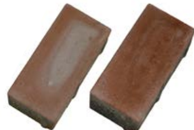
Povrch dlažby s vápenným výkvětem před čišťením a po vyčištění Rebanitem S
