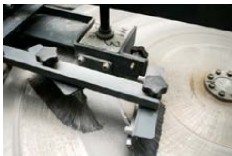
DLAŽBA PŘI ZKOUŠCE OBRUSNOST POVRCHU
