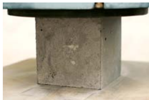
BETON PŘI ZKOUŠCE PEVNOST V TLAKU
