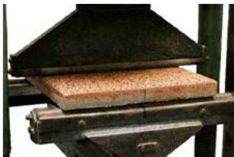
DLAŽBA PŘI ZKOUŠCE PEVNOST V DHYBU
