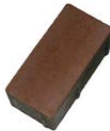
Povrch dlažby bez vápenného výkvvětu
